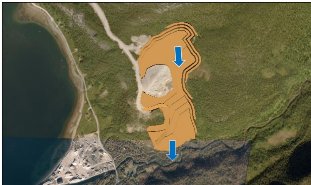
Figur 13.2. Planlagt utvidelse av dagbruddet Geresgohppi /vinterbruddet vises med gulbrun farge. Blå piler viser fallretning og indikerer avrenningsretning for overvann.
